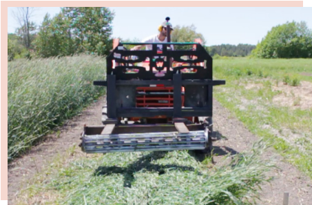
Photo 2. Le rouleau à crêper que le père d'Isabelle a fabriqué à l'aide d'une pièce démontée d'une vieille faucheuse qu'ils ont modifiée pour s'adapter aux fourches à palettes de leur tracteur. Pour une vidéo complète du rouleau à crêper en action, visitez: efao.ca/no-till-fall-broccoli-2020 .
